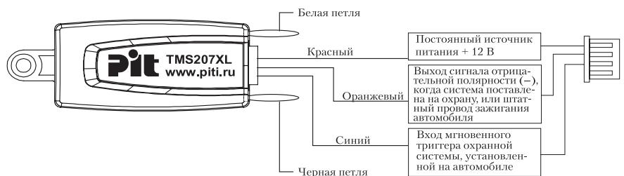
**Красный провод (постоянное питание +12 В).** Подключите данный провод к постоянному источнику питания +12 В.
