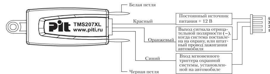
**Красный провод (постоянное питание +12 В).** Подключите данный провод к постоянному источнику питания +12 В.
