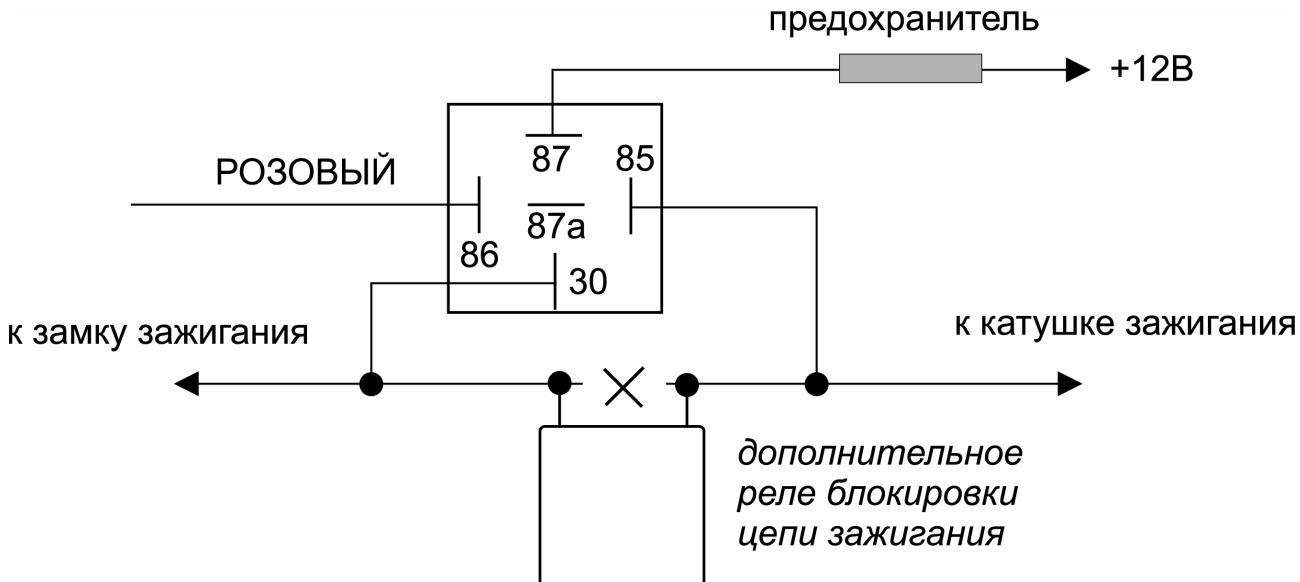
**С)** Если функция РОЗОВОГО провода запрограммирована как **«отрицательный выход для управления освещением салона автомобиля»**, то данный провод системы будет замыкаться на «массу», включая освещение салона автомобиля, в следующих случаях:
