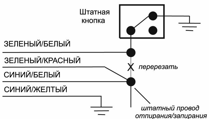
5) 5-проводная система центрального замка переменной полярности
