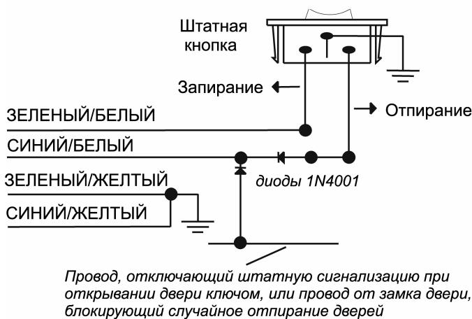
4) 4-проводная система центрального замка с управлением отпирания по минусу и управлением запирания отсутствием импульса
