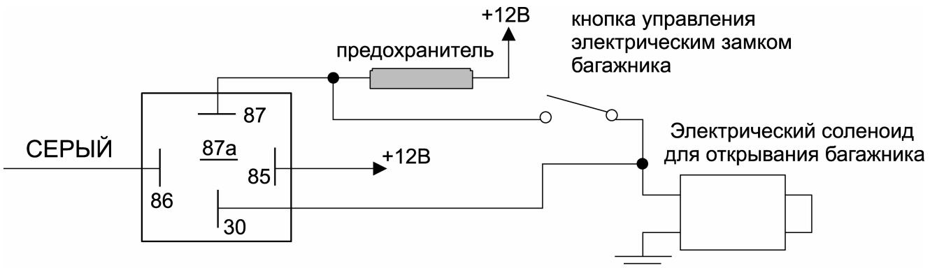
Б) Сигнал, подаваемый на СЕРЫЙ провод системы, может быть запрограммирован при установке системы (программируемая функция № 2/6) как:
