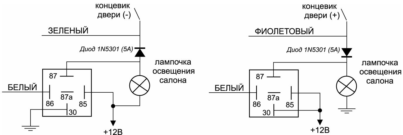
А) Если функция БЕЛОГО провода запрограммирована как «**отрицательный выход для управления внутрисалонным освещением**», то **данный провод системы будет замыкаться на «массу»**, включая освещение салона автомобиля, в следующих случаях:
