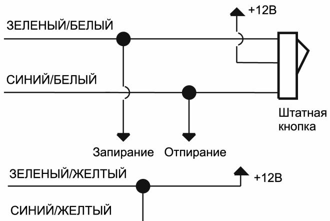
3) 3-проводная система центрального замка с управлением по минусу на автомобилях со штатной сигнализацией или с защитой от случайного отпирания дверей детьми
