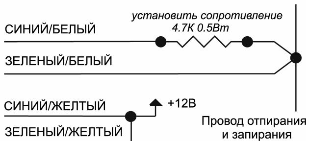
8) Вакуумная система центрального замка (автомобили Мерседес-Бенц, Ауди)
