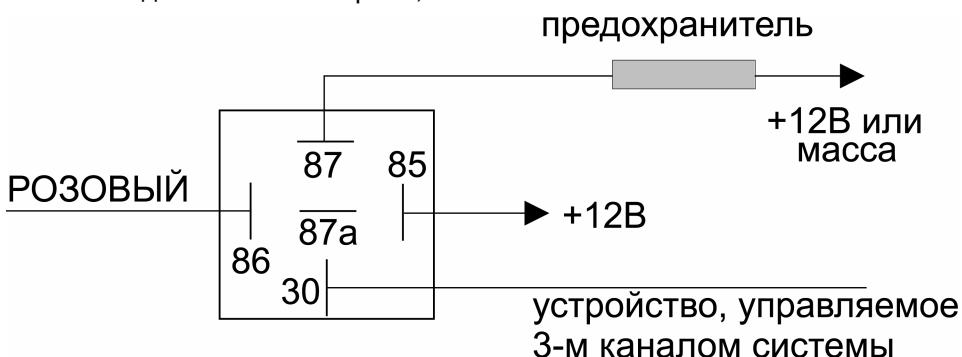
**В)** Вы можете также использовать выход РОЗОВОГО провода системы для того, чтобы система подавала питание на замок зажигания в течение определенного времени. **В этом случае Вы сможете ставить систему в режим охраны с заведенным двигателем, не оставляя ключи в замке зажигания** (если включена программируемая функция № 1/13):
