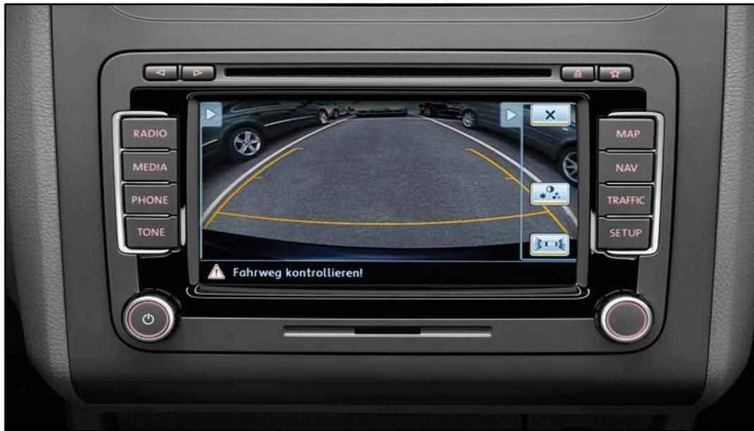
Если после активации камеры заднего вида и при включении задней передачи на экране появляется только изображение работы парктроника, необходимо активировать одновременное отображение камеры и парктроника (см. следующий пункт).
