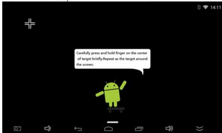
**Внимание!** В случае, если в видеоинтерфейсе отсутствует **SD** карта памяти или **DIP** переключатель **№6** установлен в положение «**Вкл.**», процедуру калибровки сенсорной панели требуется выполнять при каждом запуске устройства.
