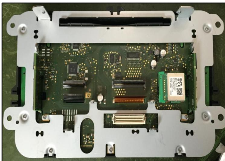
Установите переходники с платой управления сенсорной панели и видеосигнала.
