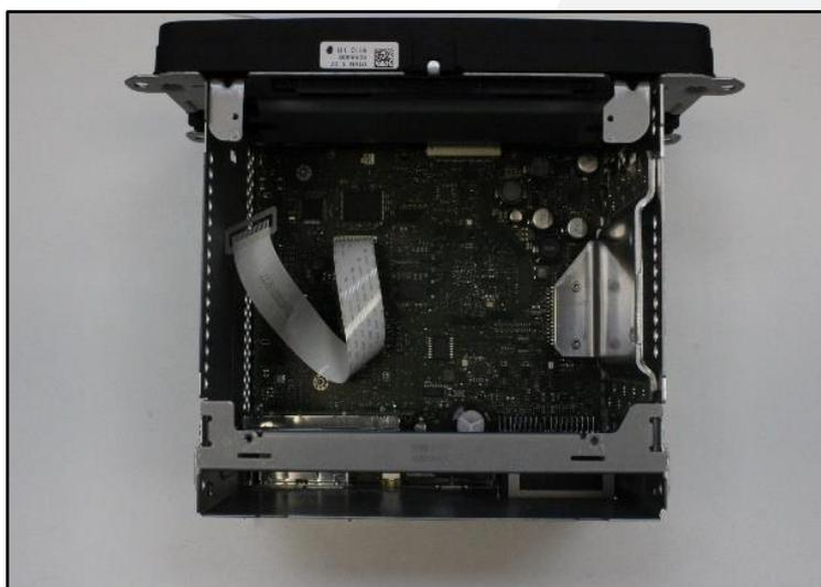
Выкрутите 9 винтов крепления передней панели магнитолы и отсоедините её.
