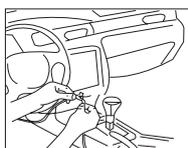
2. Провод питания главного модуля системы подключается к дополнительному проводу питания (АСС) на замке зажигания автомобиля.
