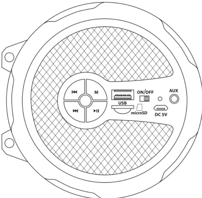
**DC 5V** - Разъем для подключения провода питания.
