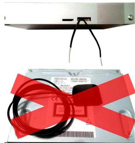
GPS антенна должна быть установлена в подпанельное пространство, не должна устанавливаться на магнитолу, а кабель не должен быть скручен в кольцо.
