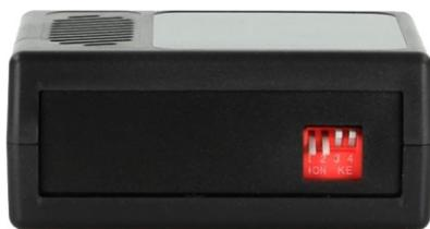
Перед установкой убедитесь, что переключатели на интерфейсе установлены в соответствии со следующей информацией: Установите переключатель 1 в положение "Вкл." при установке стереосистемы Pioneer и "Выкл." при установке
