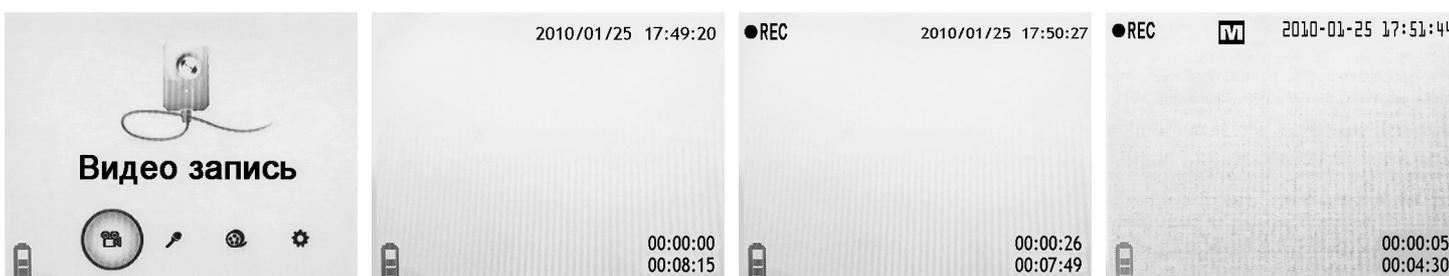
Для входа в режим «**Видео запись**» с «**Рабочего Стола**», используйте кнопки [◀] или [▶] → [OK]. Этот режим предназначен для записи видео/аудио файлов от видеоглазка, подключенного к разъему [Av/in]. Настроить видеорегистратор на нужную работу можно в меню «**Настройки**» и в окне «**Видео разрешения**».
