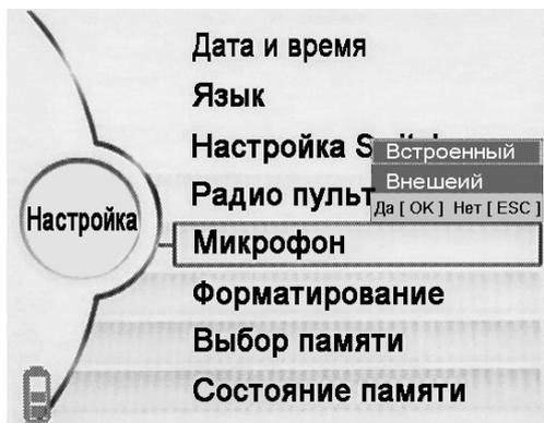
Настройка активирует встроенный или внешний микрофон. Эта настройка только для аудио записи через следующие режимы: «Аудио запись» - **Запись Звук Обычный**; **Запись Звук Быстрый**; **Запись Звук Дистанционный**.
