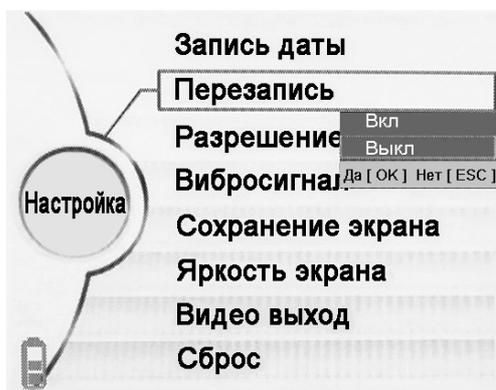
Эта функция включает или выключает перезапись записанных видео файлов. После заполнения памяти будет автоматически удален самый ранний файл и на его место запишется новый видео файл. Используя кнопки [«] или [»], выберите нужное значение «Вкл» или «Вык» → [OK]. Для отмены → [ESC].
