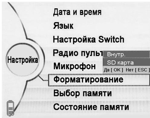
Данный режим предназначен для форматирования памяти – внутренней или карты памяти microSD. Используя кнопки [◀] или [▶], выберите нужную память «Внутр.» или «SD карта» → [OK]. Для отмены → [ESC].
