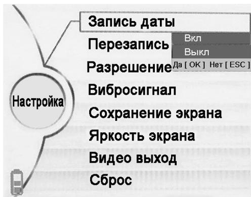
Эта функция включает или выключает отображение даты и времени на экране во время видео записи. Используя кнопки [«] или [»], выберите нужное значение «Вкл» или «Вык» → [OK]. Для отмены → [ESC].
