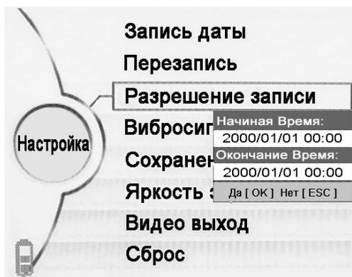
Эта функция включает или выключает автоматическую видео/аудио запись в определенный промежуток времени сразу после включения видеорегистратора.
