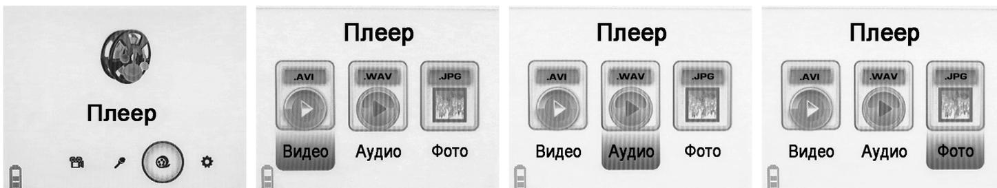
Для входа в режим «Плеер» с «Рабочего Стола» используйте кнопки [◀] или [▶] → [OK]. Этот режим предназначен для воспроизведения записанной видео-, аудио-, фото- информации на встроенном мониторе видеорегистратора. Для выхода из этого режима на «Рабочий Стол» → [ESC].
