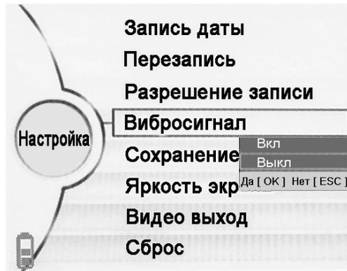
Эта функция включает или выключает вибросигнал видеорегистратора. Используя кнопки **[«]** или **[»]**, выберите нужное значение **«Вкл»** или **«Вык»** → **[OK]**. Для отмены → **[ESC]**.
