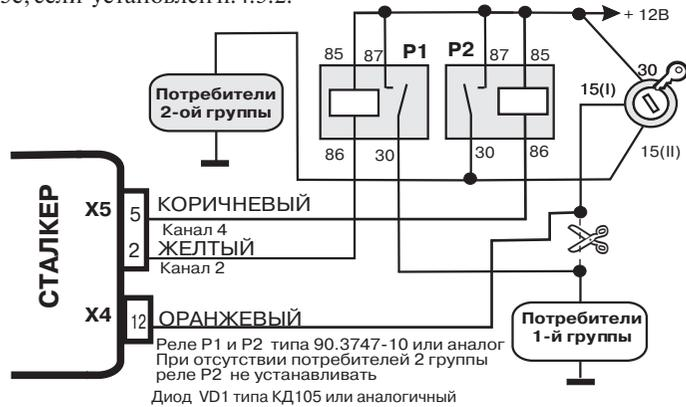
Рис. 15. Схема подачи зажигания при постановке на охрану с заведённым двигателем без ключа в замке зажигания
