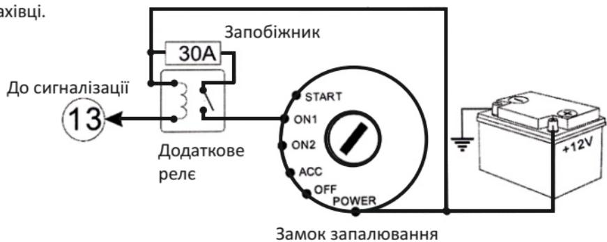
**Увімкнення функції турботаймера**
