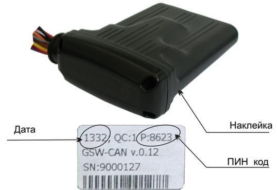
Рис 1. Системный блок GSW-CAN и идентификационная наклейка.
