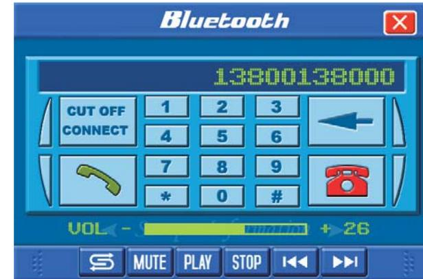
Устройство предоставляет функцию Bluetooth hands-free. Если ваш телефон оснащен интерфейсом Bluetooth и поддерживает функцию A2DP, то вы можете не только принимать и совершать звонки, но и проигрывать музыку с телефона.
